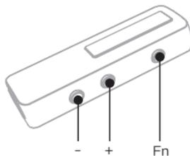
1. 正しく USB ケーブルを接続した後は、デフォルトモードになり、+/- ボタンでボリューム調整ができます
